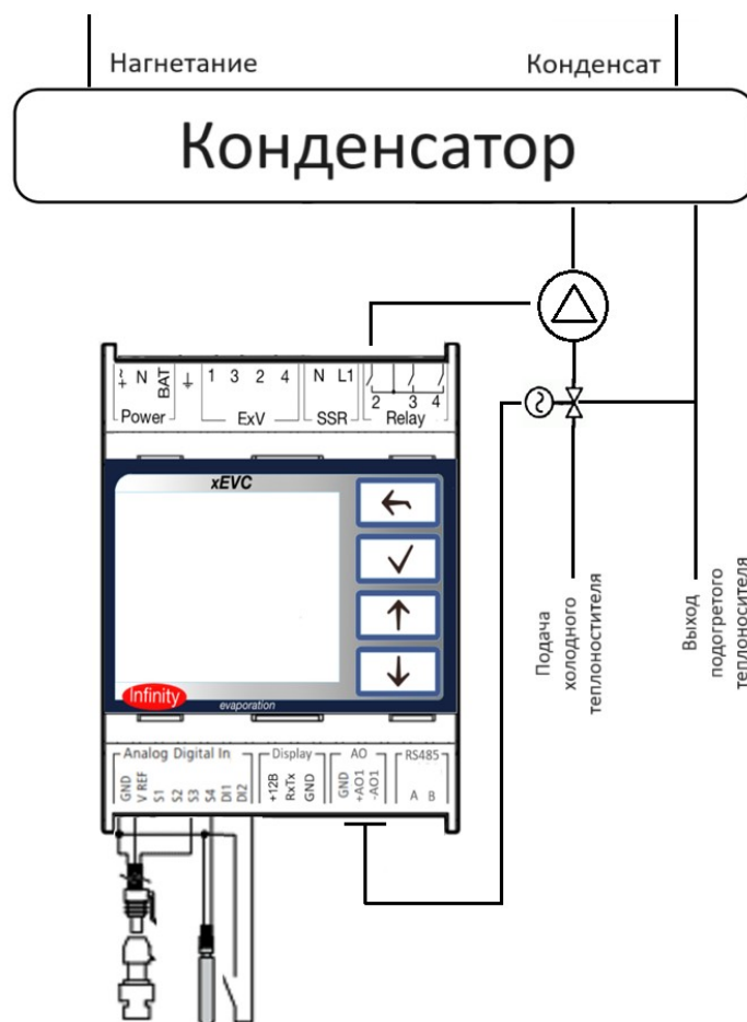
Рис 2.7.1 Схема плавного управления жидкостным конденсатором в насосно-смесительной схеме.
