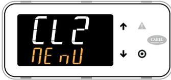
Категория «CL2» (Компрессоры Линии 2): все параметры, относящиеся к конфигурации и регулированию компрессоров Линии 2 (за исключением модели CO<sub>2</sub>)
