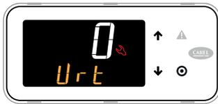
1. Включите контроллер и дождитесь, пока на дисплее отобразится первый параметр «Urt» (регулирование по температуре или давлению);
