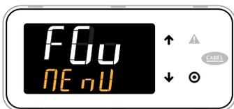
Категория «FGV» (Клапан FGV): все параметры, относящиеся к работе клапана FGV (только модель CO<sub>2</sub>)
