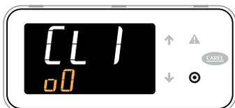
5. Нажмите стрелку ВНИЗ: параметр CL1 показывает состояние отдельных компрессоров Линии 1: ( ) компрессор выключен, (o) компрессор работает при частичной нагрузке и (O) компрессор работает с максимальной производительностью
