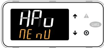
Категория «HPV» (Клапан HPV): все параметры, относящиеся к работе клапана HPV (только модель CO<sub>2</sub>)
