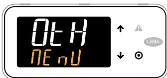
Категория «OтH» (Другие функции): все параметры, относящиеся к дополнительным функциям для компрессоров или других устройств в агрегате
