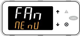
Категория «FAη» (Вентиляторы конденсатора): все параметры, относящиеся к конфигурации и регулированию вентиляторов конденсатора
